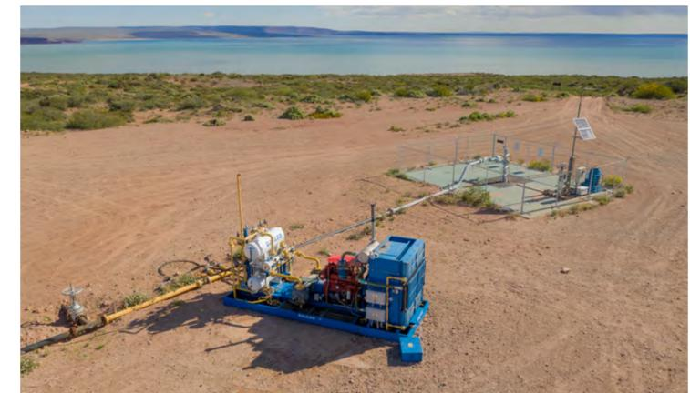
Paquete compresor MX de Galileo utilizado en boca de pozo y en EOR
